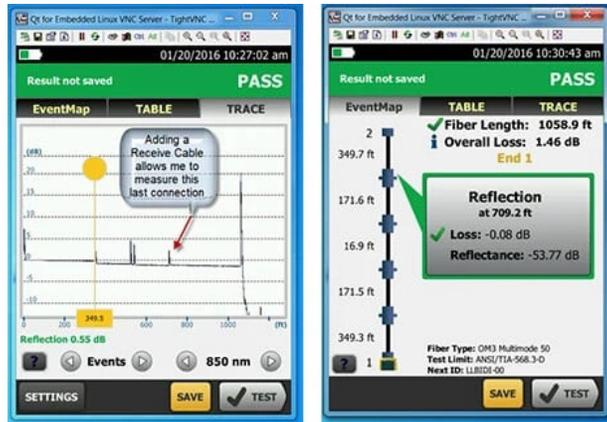
图 5. 在线缆远端添加发射和接收光纤后，OTDR 可测量链路中第一个和最后一个连接器的损耗。
