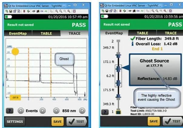
图 11. “鬼影”是实际事件的强反射信号导致的非真实存在的事件。
