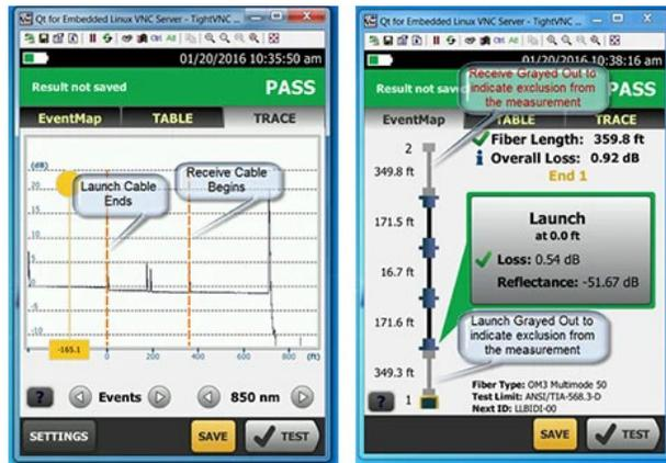
图 6. 迹线包括所测试链路开头和结尾处的发射和接收光纤。右侧显示的 EventMap 使用启动补偿从测试结果中移除其效果。
