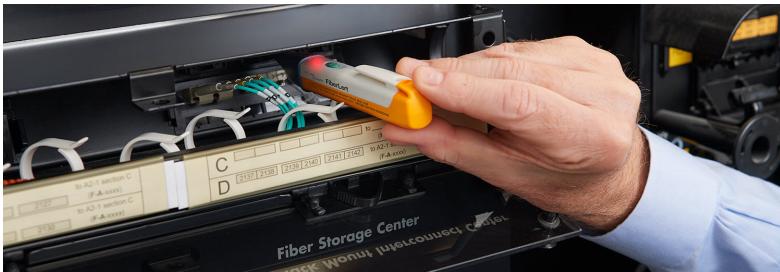
确定端口是否联机。小巧设计便于进入狭小的配线架。
